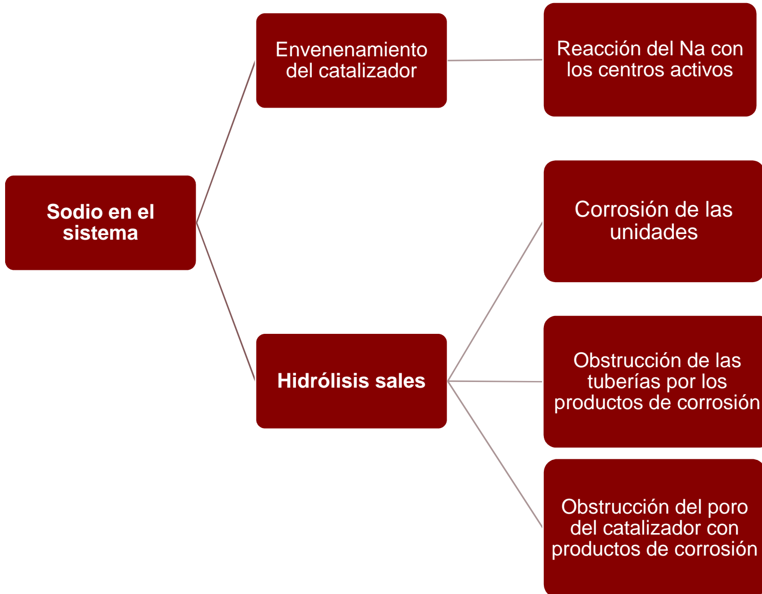
Fig 2. Deposición de productos de corrosión en el catalizador
